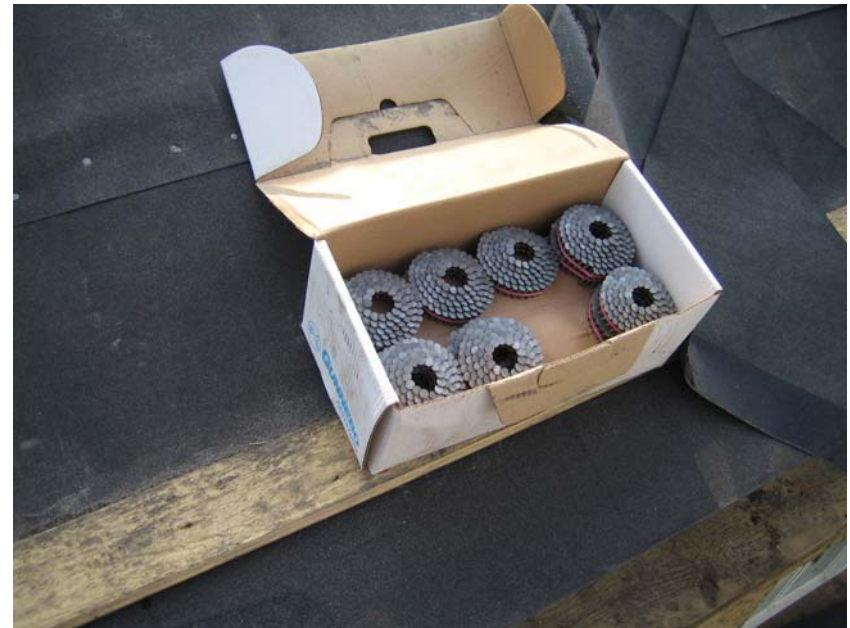
22 mm varmförzinkad pappspik på rullband för spikautomat
