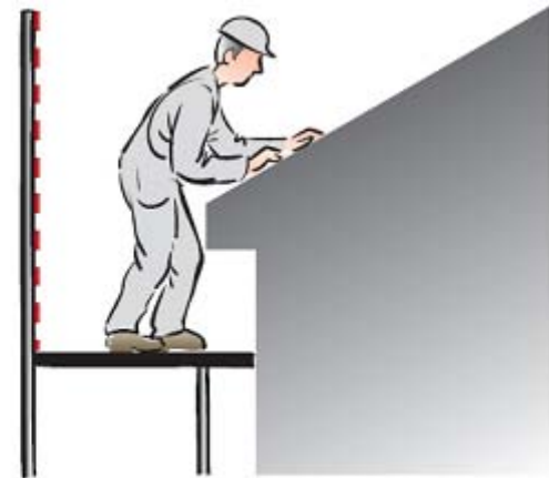
Byggnadsställning vid tak- och takfotsarbete.
