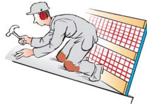
Skyddsräcke vid takarbete.
