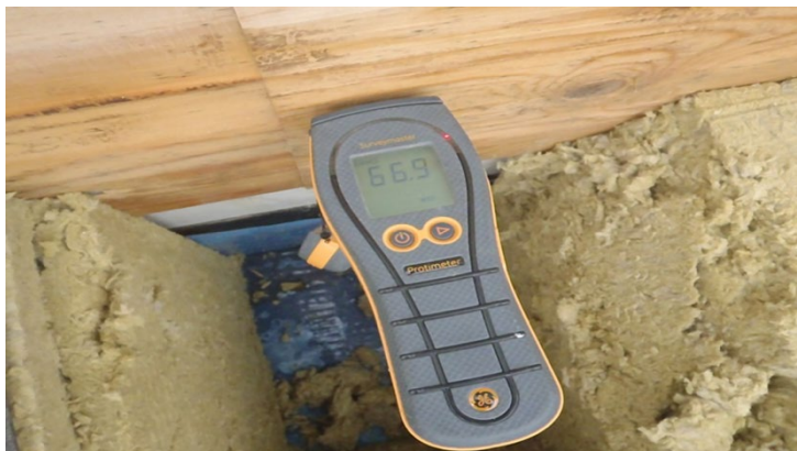
Figur 4.1.1 Uppfuktad plywood i ett kompakttak. (Foto: Eva Gustafsson)
