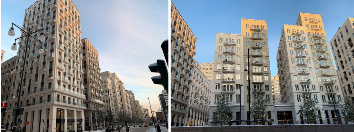
Figur 4.6 Nybyggd stadsdel, Hagastaden i Stockholm, med gator som är cirka 16 m breda och cirka 6 m mellan byggnaderna. (Foto: Paul Rogers).
