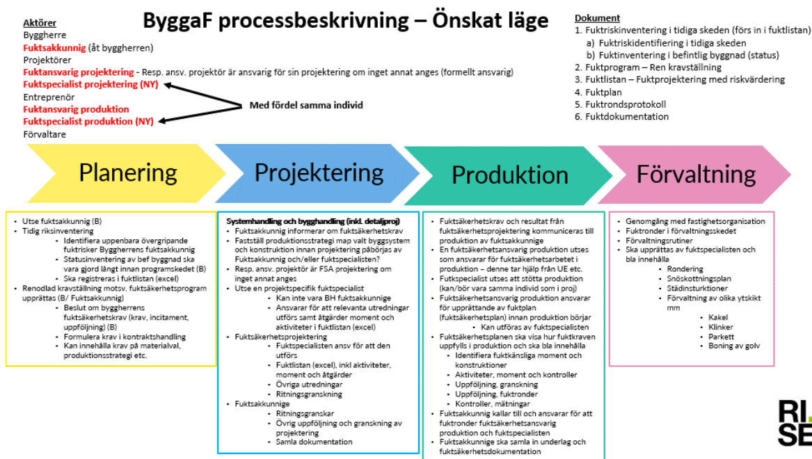
Figur 4 Önskat läge för hur fuktsäkerhetsarbetet ska utföras i byggprocessen. Begrepp och definitioner.
