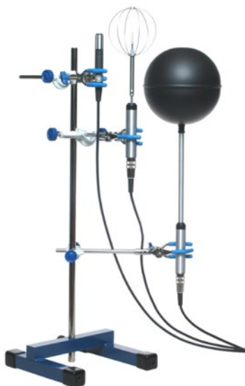
Figur 7.4 Swema-utrustning för mätning av termisk komfort inklusive mätningar av lufttemperatur, lufthastighet, luftfuktighet och svart globtermometer (som kan användas för att uppskatta medelstrålningstemperatur). (Källa: Swema 2022)
