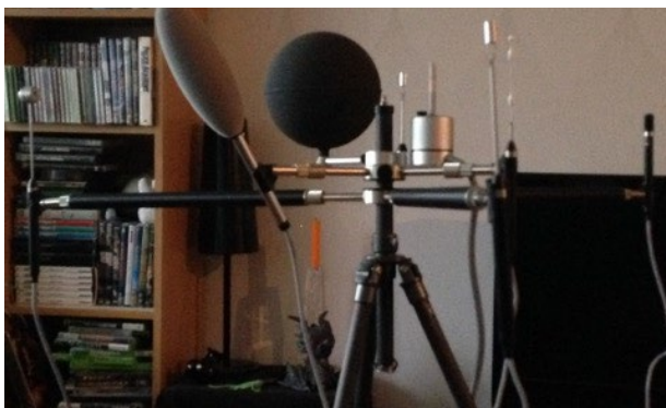
Figur 7.3 En fältmätning av termisk komfort inomhus med Innova datalogger och sensorer. (Foto: Chuansi Gao)
